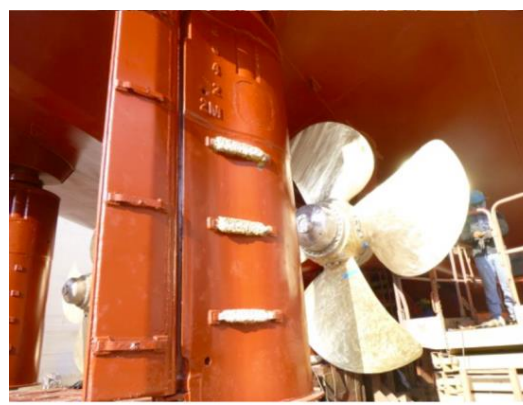
Foto 10 - Balanço de popa, leme e hélice por boreste
